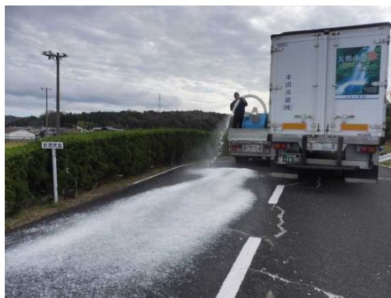
人工降雪機による積雪路の再現
