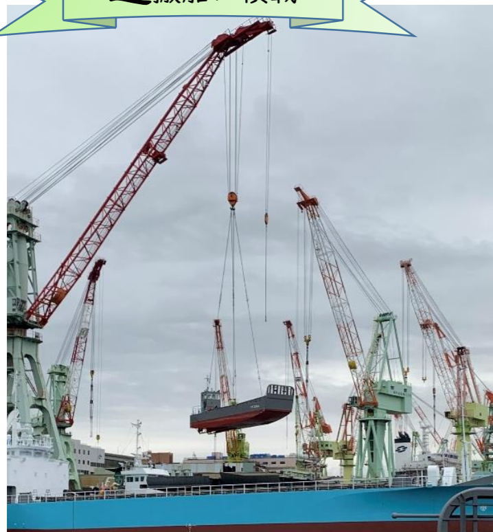
▲クレーンにて吊り上げられる交通船
