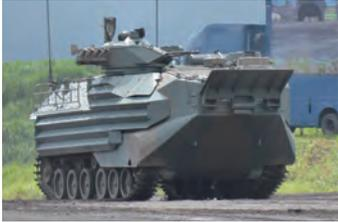
〈諸元、性能〉 全長 8.2m 全幅 3.3m 全高 3.3m
