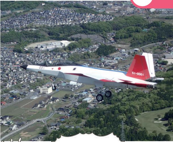
将来戦闘機に必要となる、先進的な技術を実証するための試験機。独自の機体形状はもちろん機体の一部に特殊な電波吸収材が使われている。さらに搭載されている
