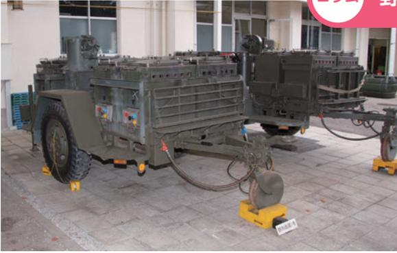
陸上自衛隊が装備する野外作業用調理器具であり、もとは隊員の野外での食事を作る器材として開発。灯油バーナーを使ったかまど6基と万能調理器などで約200人分の炊飯とおかず、汁物などの調理が同時にできます。
