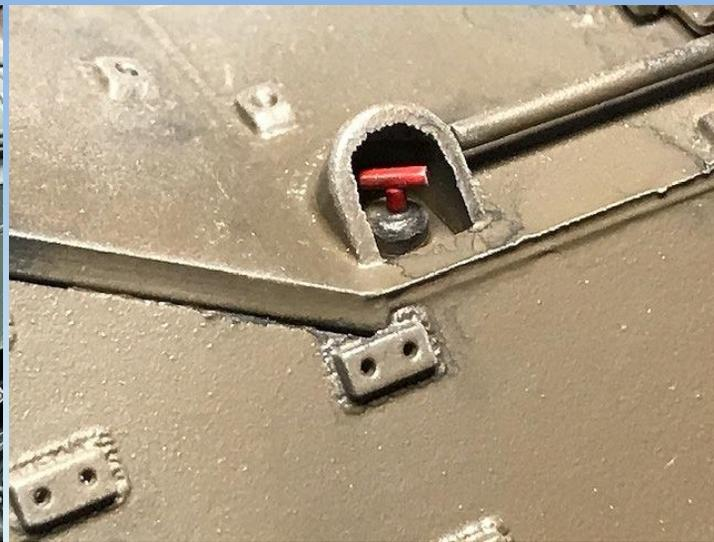
上段：車体側面の消火器操作レバーを自作。小さなところでもできる限り実車に近づけます。
