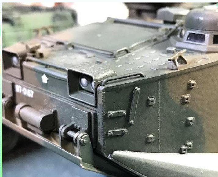
側面の四角の突起物は増加装甲等を取り付けるための受け金具です。車体前側部の方向指示器取付用ブラケットは再現されてなかったのでプラ板でそれらしく作成しました。
