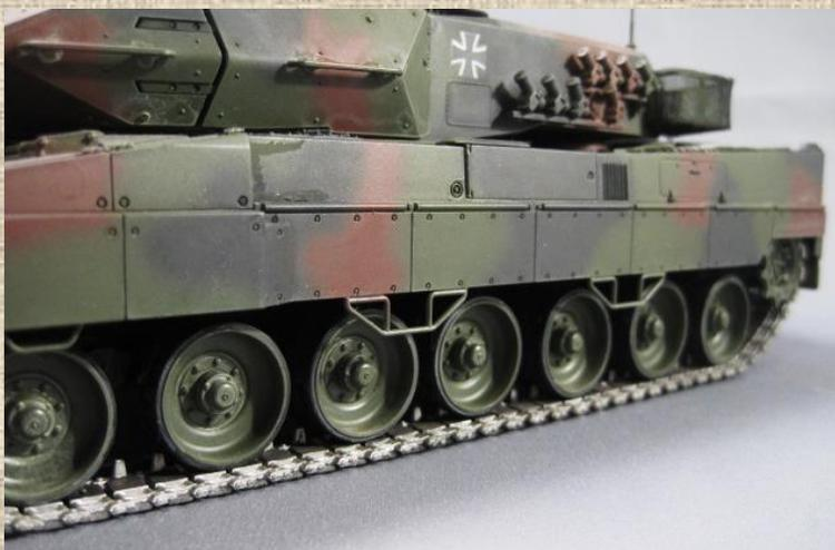
一般的に転輪の数が多いほうが不整地の凹凸を吸収し、走破しやすく乗り心地もよいといわれています。動画でレオパルドの走行シーンなんか見るとそれも納得します。もちろん、懸架装置の衝撃吸収能力も重要な要因ではあるのですが…
