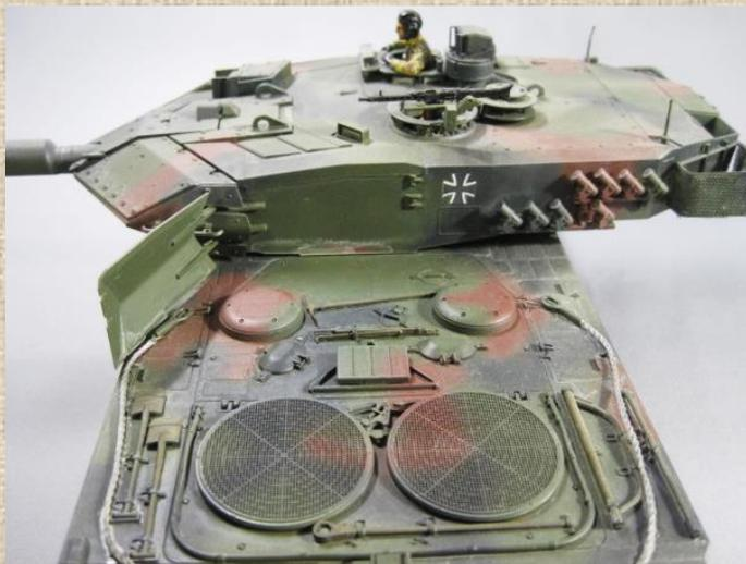
敵の対戦車ミサイル等のレーザー照準から煙で遮断する発煙弾発射機(左)。分割して発射するのかわ、一挙に発射するのかわかりませんが、ミサイルからの防護を重視していると感じてしまいます。エンジンの整備の為、砲塔を横に向けて更に側面防弾版を開かないとエンジンハッチを開放できないという得意な形状もこの模型で再現できています。整備大変そう！！
