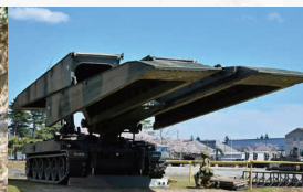
戦車橋架設訓練
