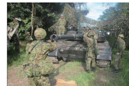
学生教育の一コマ 野外整備実習にて戦車の砲身交換を行う学生
