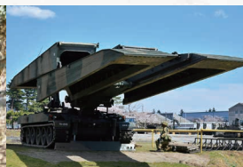
戦車橋架設訓練
