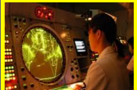
管制用レーダーで航空機を誘導
