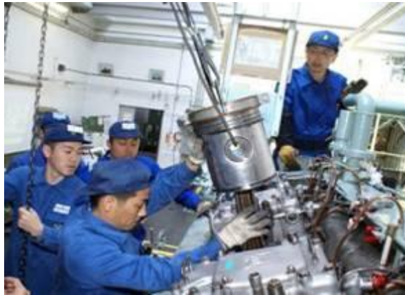
(大型機関のピストン抜き出し)
