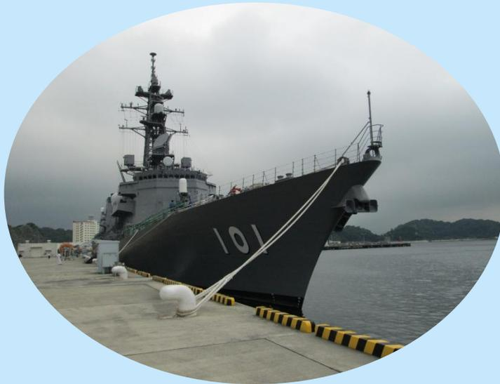
護衛艦の艦首ですが、左舷と真ん中に錨があるのが見えますが右舷には在りません。理由は、護衛艦の艦首に「バウ・ソーナー」があって左右にしか錨がないと投錨したときに「バウ・ソーナー」に錨鎖が当たり損傷する恐れがあるため、真ん中に錨を搭載しています。
