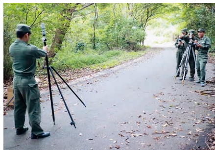
測量実習：GNSS受信機を用いた干渉測位により、三次元的な位置情報を取得する。
