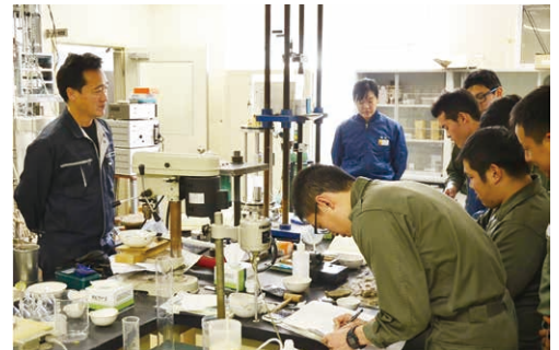
土質・水理実験：土の物理的性質を把握するために、土の物性を計測する。
