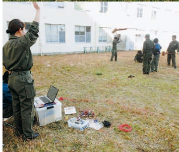
地球海洋学実験Ⅱ（地震学）：ハンマーを使った人工地震の記録から地下構造を推測する。
