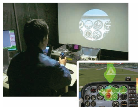
航空機操縦時の視線計測と有効視野の解析 (脳情報処理研究室)
