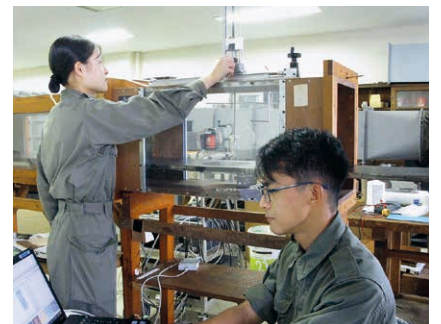
卒業研究（熱工学実験室）：熱線流速計を用いた平板乱流境界層の速度計測。
