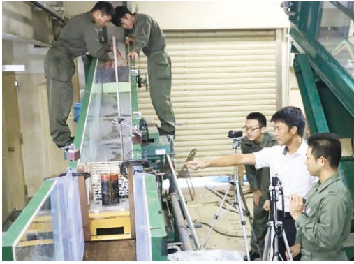
鋼構造学：土石流を発生させ、その挙動や構造物への衝突現象を理解する。
