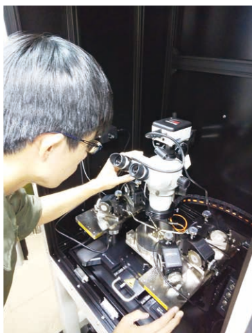
試作半導体チップをプローブ電極へ正確に置く 操作 (電子回路研究室)
