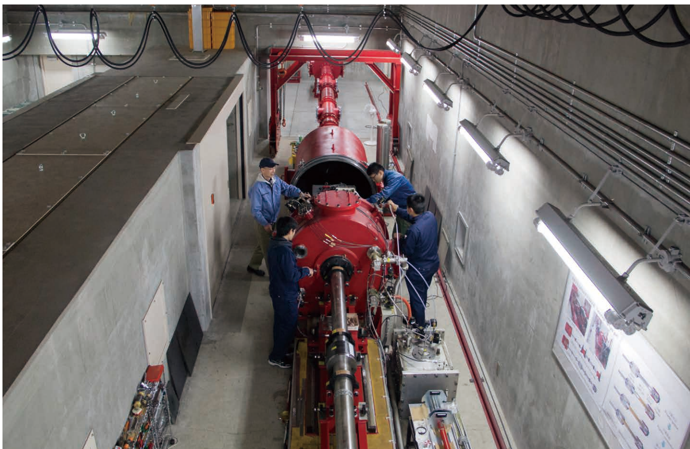
大型の2段式超高速衝突実験装置。微小隕石や宇宙デブリを模擬した飛翔体を超高速で打ち出し、対象物に衝突させて損傷・破壊状態を評価する実験(右下写真)を行っている様子。(高速弾道学研究室)
