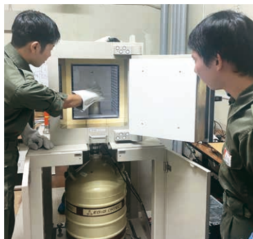
微量放射性物質を検知するための放射性検出器 (放射線防護研究室)
