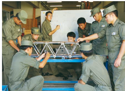
構造・コンクリート実験：橋梁模型に荷重を作用させ、変形量を理論値と比較・検証する。
