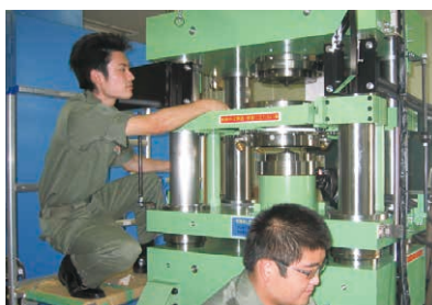
卒業研究（機械材料実験室）：超高压 PAS (Plasma Activated Sintering) 装置を用いたセラミック粉末の完全緻密化実験。
