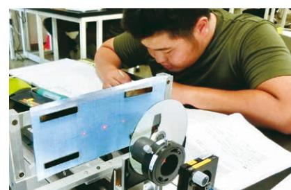
レーザー光の干渉の実験
