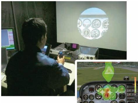
航空機操縦時の視線計測と有効視野の解析
