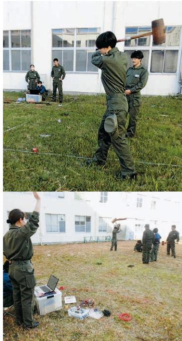
地球海洋学実験Ⅱ（地震学）：ハンマーを使った人工地震の記録から地下構造を推測する。
