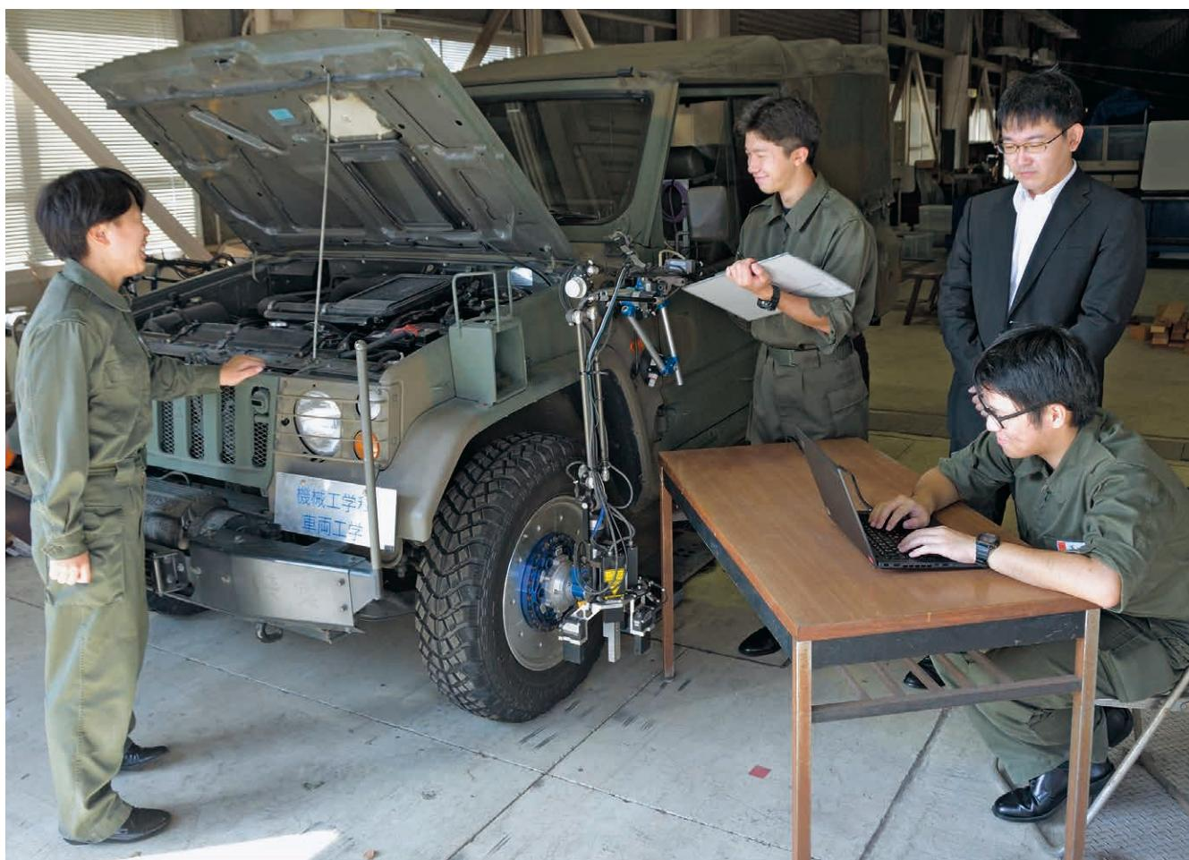
卒業研究（自動車工学実験室）：計測車両で収集したデータを解析してタイヤの力学的特性を明らかにする。
