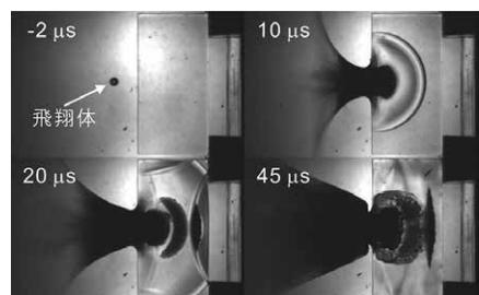
ポリカーボネート球が秒速6kmでポリカーボネートロックに衝突した時の超高速度撮影画像（高速弾道学研究室）
