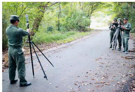
測量実習：GNSS受信機を用いた干渉測位により、三次元的な位置情報を取得する。
