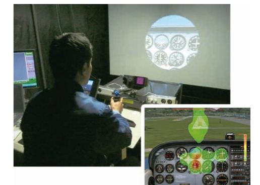
航空機操縦時の視線計測と有効視野の解析(脳情報処理研究室)
