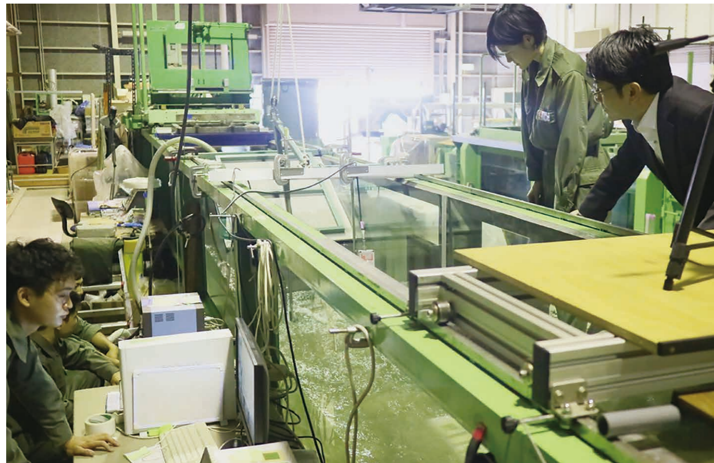
土質・水理実験：人工的に波を発生させ、水や土砂基盤の性質や運動を理解する。
