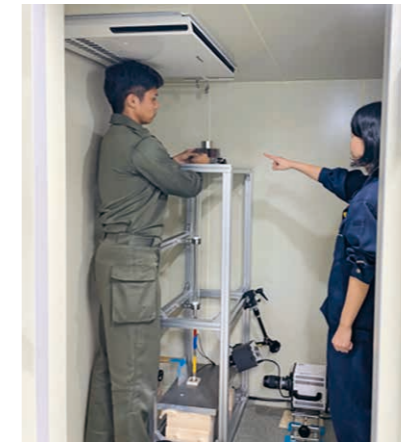
卒業研究（強度設計実験室）：冷凍室内に設置した自作の衝撃変形試験装置で低温材料強度特性を調べる。
