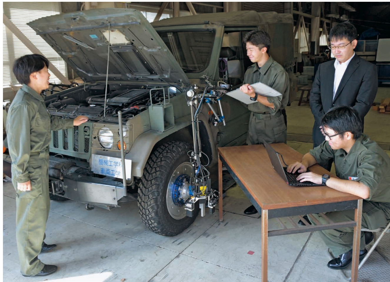
卒業研究（自動車工学実験室）：計測車両で収集したデータを解析してタイヤの力学的特性を明らかにする。
