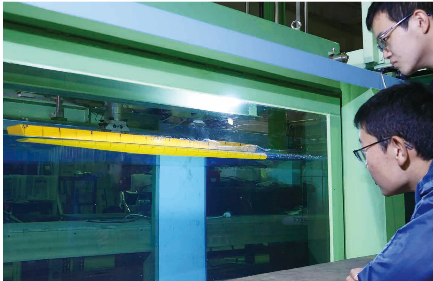
卒業研究（船舶工学講座）：高速回流水槽を用いた模型船の実験
