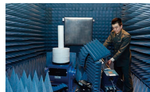
電波暗室でのアンテナ・レーダ断面積測定
