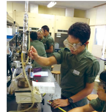
基礎科学実験(化学分野:酢酸エチルの合成)合成した酢酸エチルは精製した後、ガスクロマトグラフィーで分析します。
