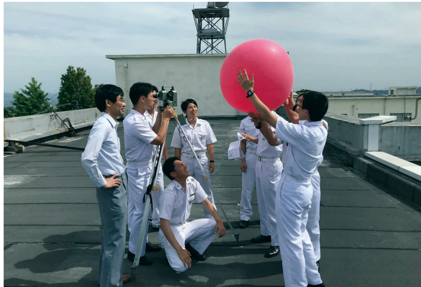
地球海洋学実験Ⅰ（高層気象観測）：バルーンを上げて上空の温度、湿度、気圧などを計測。気象学の基礎を理解する。
