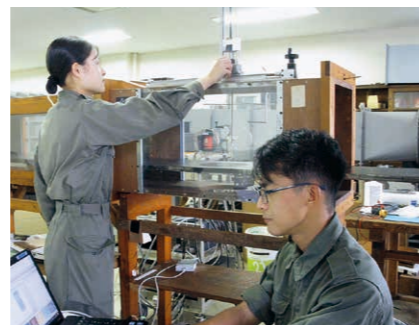
卒業研究（熱工学実験室）：熱線流速計を用いた平板乱流境界層の速度計測。
