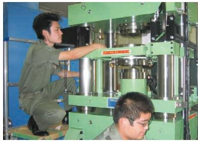
卒業研究（機械材料実験室）：超高圧 PAS (Plasma Activated Sintering) 装置を用いたセラミック粉末の完全緻密化実験。
