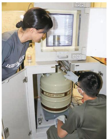
微量放射性物質を検知するための放射性検出器（放射線防護研究室）
