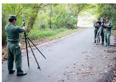
測量実習：GPSを用いた水準測量
