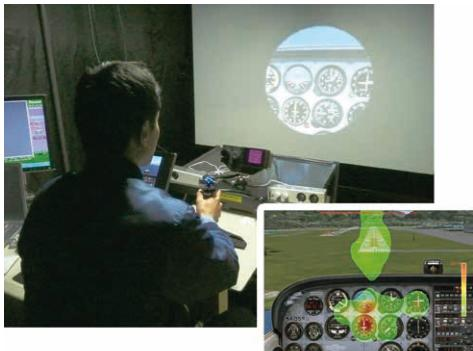
航空機操縦時の視線計測と有効視野の解析（脳情報処理研究室）
