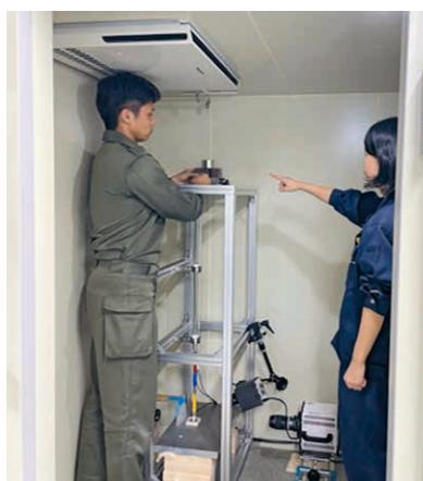
卒業研究（強度設計実験室）：冷凍室内に設置した自作の衝撃変形試験装置で低温材料強度特性を調べる。
