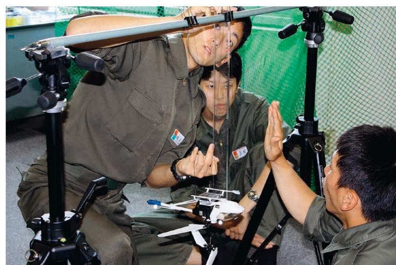
卒業研究（計測制御実験室）：RC ヘリコプターの飛行制御実験のための模型諸元計測
