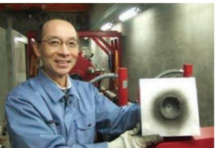
超高速衝突によってアルミニウム板に形成されたクレーター
