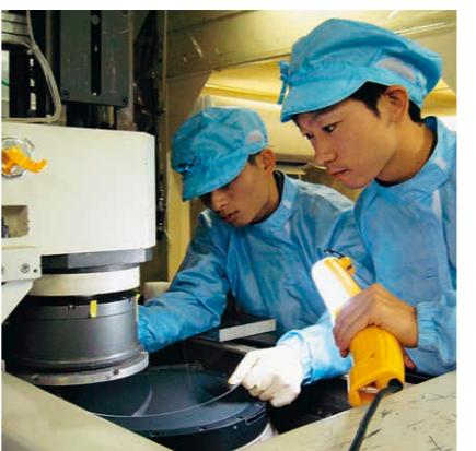
卒業研究（制御加工実験室）：大型基板用超精密研磨装置の開発を通して精密加工を学ぶ。
