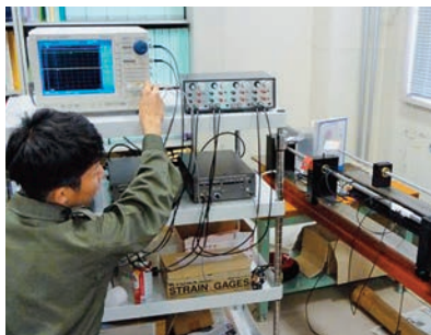
卒業研究（強度設計実験室）：衝撃変形試験装置によって自動車衝突時の材料強度特性を調べる。
