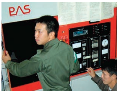
卒業研究（機械材料実験室）：PAS（Plasma Activated Sintering）装置を用いたセラミック粉末の加圧焼結実験。
