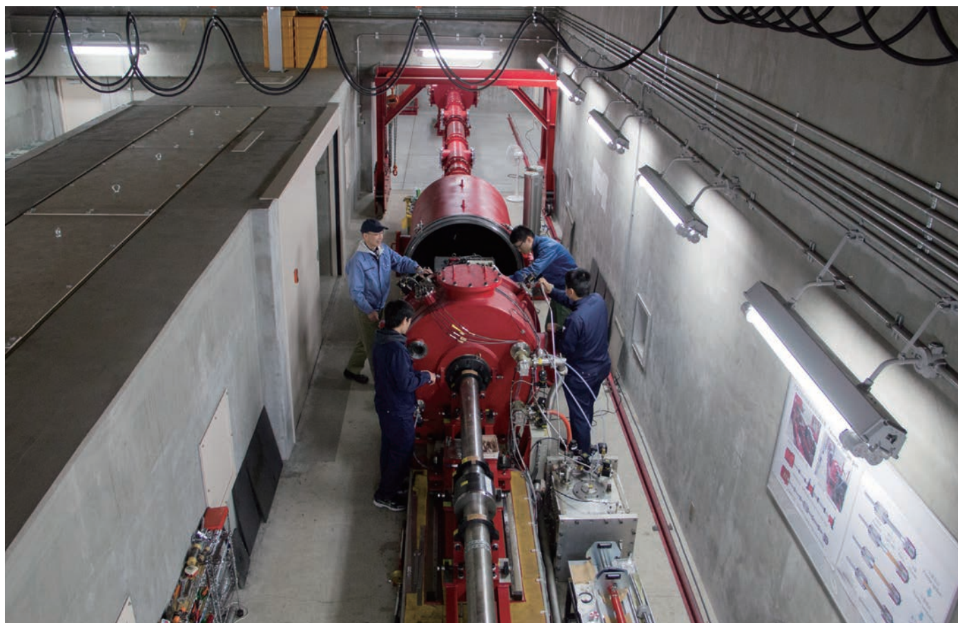
大型の2段式超高速衝突実験装置。微小隕石や宇宙デブリを模擬した金属球（秒速約8km）を打ち出し、金属板に衝突させてクレーター（右下写真）を形成する実験を行っている様子。
