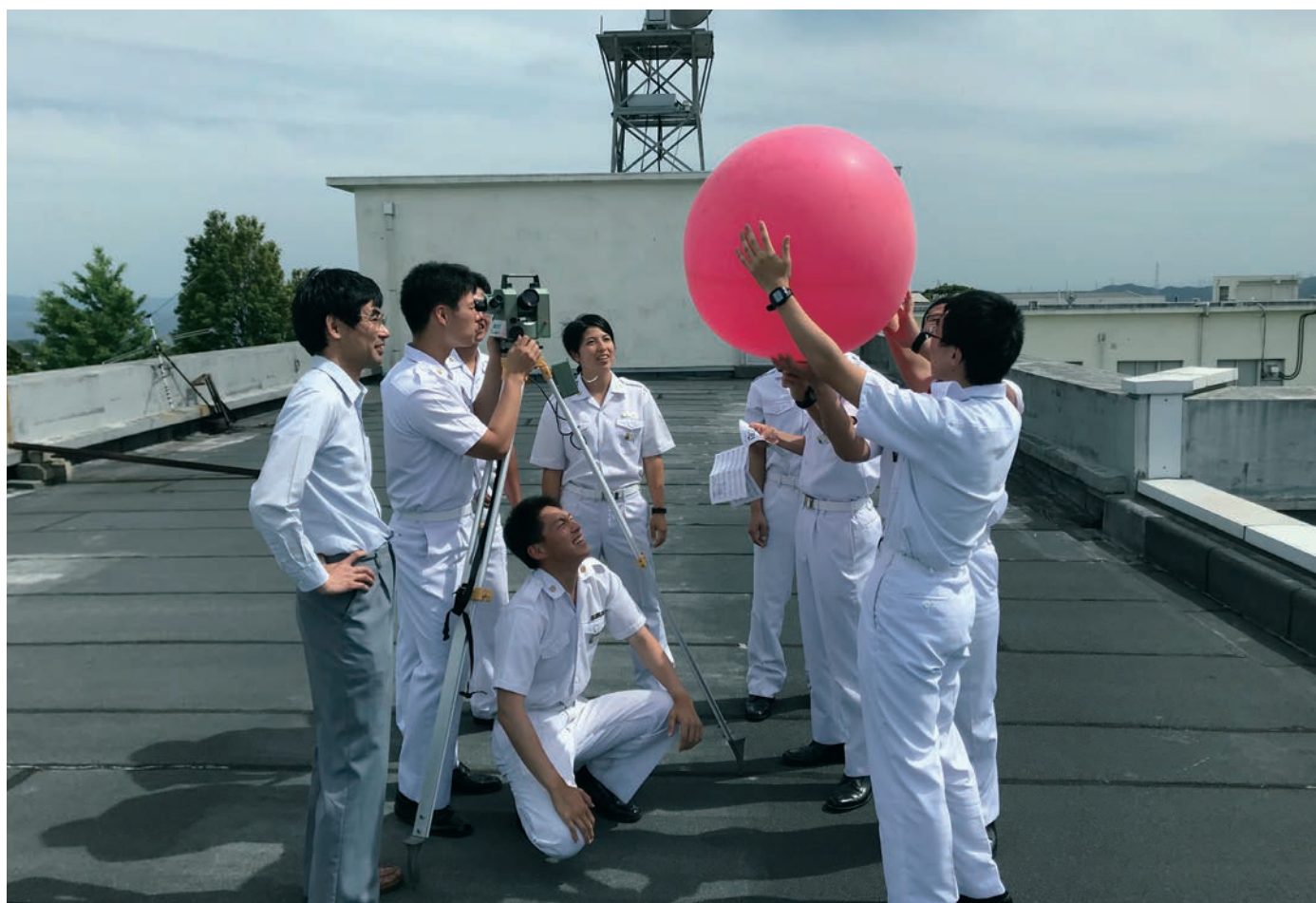
気象学概論：バルーンを上げて上空の温度、湿度、気圧などを計測。気象学の基礎を理解する。
