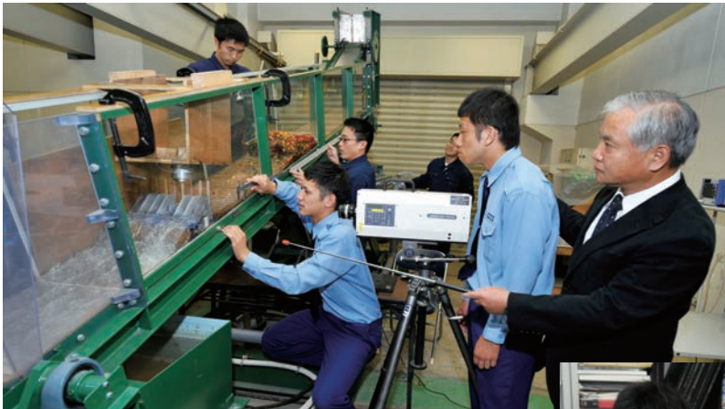
防災構造学：砂防構造物の実験
