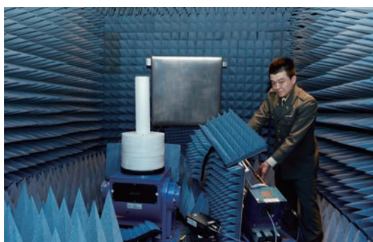
電波暗室でのアンテナ・レーダー断面積測定
