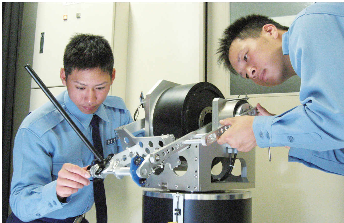
卒業研究（制御工学実験室）：複数の関節をもつロボットアームを用いた運動制御実験
