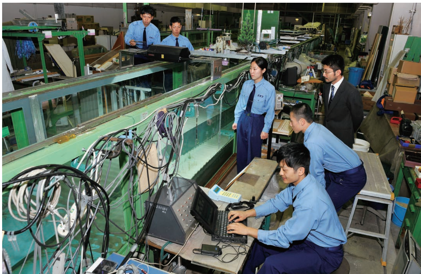
水理・土質実験：人工的に波を発生させ、水や土砂基盤の性質や運動を理解する。
