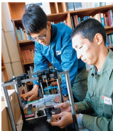
卒業研究（機械力学実験室）：振り子を使った振動伝搬の実験
