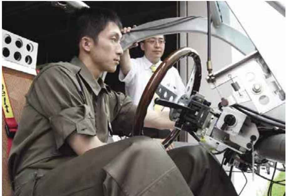
卒業研究（機械運動実験室）：自律的に操舵・制御駆動できる超小型EVを用い、ドライバーへの運転支援を設計する。
