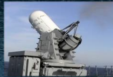
③ 高性能20ミリ機関砲 (20mm Close-in Weapon System) 近接する対空、水上目標に対処するための自動機関砲です。
