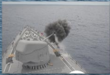
① 127ミリ速射砲 (127mm rapid fire Gun) 対空、水上のいずれの目標にも対応可能な砲です。
