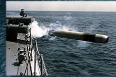
④ 3連装短魚雷発射管 (Triple Torpedo Tubes) 潜水艦攻撃用の魚雷を圧縮空気で発射する装置です。
