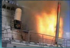
② 垂直式短SAM/アスロック発射装置 (Short Range SAM/ASROC Vertical Launching System) 対空ミサイル、対潜ミサイル(アスロック)が発射可能です。
