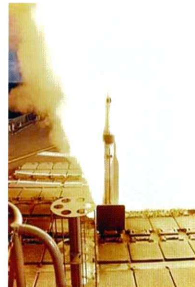
垂直式アスロック発射装置 (VLS for Anti Submarine Rocket) 潜水艦攻撃用の魚雷を遠距離に飛ばすため、魚 雷の後部にブースターロケットを装備して発射 する装置です。
