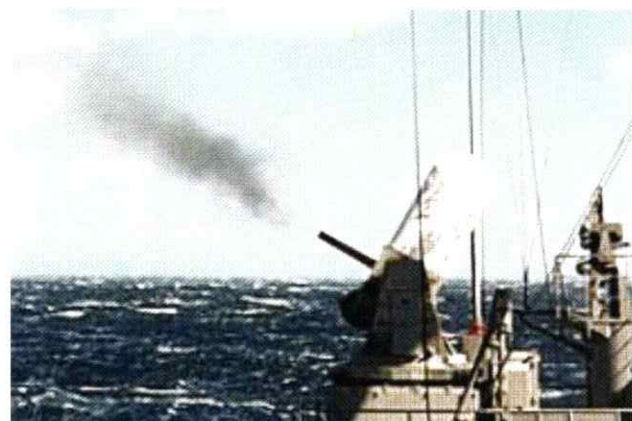
高性能20mm機関砲 (20mm Close In Weapon System) 近接する対空・対水上目標に対処するための自動 (手動)発射機関砲です。
