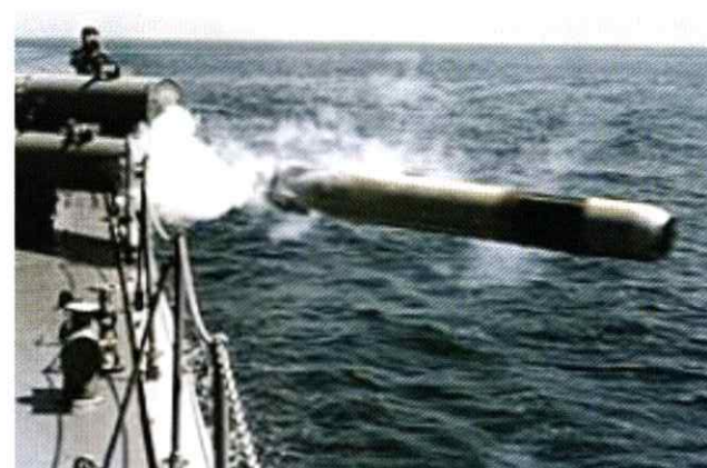
3連装短魚雷発射管 (Torpedo tubes) 潜水艦攻撃用の魚雷を圧縮空気で発射する装置 です。
