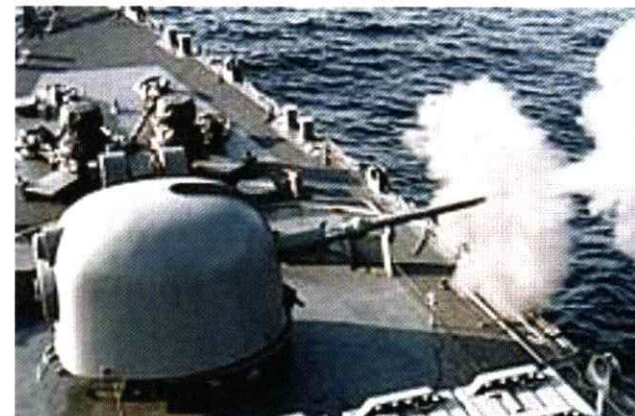
6 2口径76mm速射砲 (76mm rapid fire) 対空・対水上いずれの目標にも対処可能な無人砲 です。
