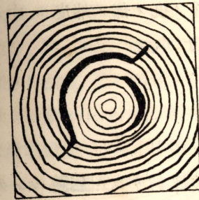
(ハ) 輪狀割裂、第五圖ニ示セル如ク、年輪ノ方向ニ現ハルル疵ニシテ、年輪間ノ固着カガ失ハレ、内部ト外部ト分離スル爲ニ生ズルモノナリ、通常ハ全輪ヲナサズ、唯一側ニ於テノミ起ルモノナリ、而シテ此ノ疵ハ、多クハ樹木ガ強風ノタメニ打倒サルルカ、霜ニ襲ハルルカ、又ハ蟲害ニ因リテ起ルモノナリ、
