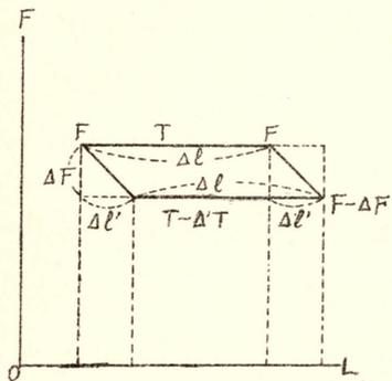
膨脹ヲナサシメ  $l + \Delta l$  トナシ更ニ斷熱膨脹ニテ  $l + \Delta l + \Delta l'$  ニ到ラシムレバ溫度ハ  $T - \Delta T$  トナリ張力ハ  $F - \Delta F$  トナルベシ、次ニ熱量  $Q_2$  ヲ奪ヒテ等溫壓縮ヲナサシメ  $l + \Delta l'$  トシ、更ニ斷熱壓縮ニテ元ノ状態ニ戻ラシムベシ、此ノ時ナス仕事ハ近似的ニ
