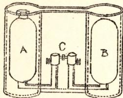
壓縮セル空氣ヲ充タシ、Bハ眞空ニシテ全部ヲ同温ニシテ水熱量計中ニ置キ、次ニ活栓Cヲ開キテAノ空氣ヲB内ニ擴散セシメ、此ノ際ノ熱量計ノ溫度變化ヲ見タルニ熱量計ハ何等熱量ヲ授受セズ、溫度ハ一定ナル
