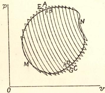
温膨脹ヲナス際ニ獲得セル熱量ヲ  $dQ_m$ ,  $T_m$  ナル温度ニ於テ等温壓縮ヲ受クル際ニ放出セル熱量ヲ  $dQ_n$  トセバ
