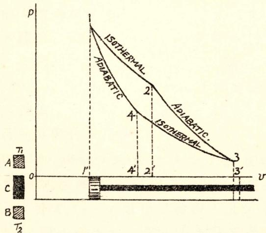
不良導體ナル筒内ニ滑動ニ際シ少シモ摩擦ナキ吸鑿ヲ有シ、此ノ吸鑿モ亦完全ニ熱ノ不良導體ナリトス、之ニ反シ筒ノ頂部ノミハ熱ノ良導體ニシテ、必要ニ應ジ之ヲ遮斷シ得ル蓋Cナル熱ノ不良導體ヲ別ニ裝備セルモノナリ、A, Bハ夫々熱源及冷却器ニシテ之等ハ其ノ容量無限ニシテ、一定量ノ熱ヲ之ニ與ヘ又之ヨリ取ルモ、ソノ爲ニ溫度ノ昇降ヲ生ズルガ如キ事ナキモノトシ、且Aハ高溫度 $T_1$ ニシテ、Bハ低溫度 $T_2$ ヲ有スルモノト假定ス、而シテ操作物質トシテ完全氣體ヲ用ヒソノ全過程ハ準靜的ニシテ次ノ四過程ヨリナレリ、
