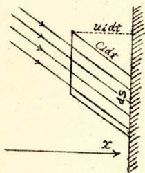
器壁上ノ微小面積ヲ  $dS$  トシ之ニ垂直ナル方向ニ  $x$  軸、平行ナル二方向ニ  $y, z$  軸ヲトリ、 $i$  群ノ分子ノ速度  $c_i$  ノ  $x, y, z$  ノ分速度ヲ  $u_i, v_i, w_i$  トセバ  $i$  群分子ノ射流ニ依リ  $dS$  面ガ  $dt$  時間ニ受クル衝突分子數ハ底面積  $dS$ 、高サ  $u_i dt$  從ツテ容積  $u_i dt dS$
