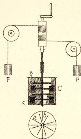
兩者間ノ數量的關係ニ就イテ初メテ直接的實驗ヲ行ヒシハ Joule 氏ニシテ、其ノ實驗ハ圖示ノ如キ水熱量計 C ノ内部ニテ羽根車 a ガ器壁ヨリノ翼 b ノ間ヲ縫ヒテ廻轉シ、水ヲ攪亂スルトキ内部摩擦ニ依ル發熱量ヲ前後ノ溫度差ヨリ計算シ、一方廻轉ニ費セル力學的「エネルギー」ハ廻轉ノ爲ニ滑車ヲ介シテ
