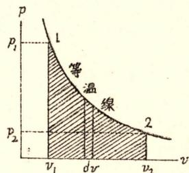
一般ニ膨脹曲線ノ方程式ガ  $pv^n = \text{const}$  ナル時ハ同様ニシテ容易ニ
