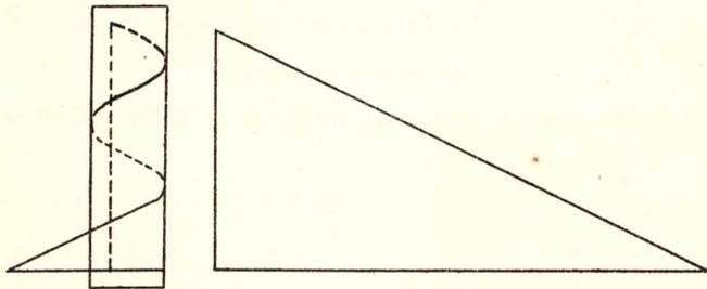
シクハ四角ノ山ヲ附スレバ下圖ノ如キ螺旋トナル、Aヲ三角螺旋、Bヲ四角螺旋ト稱ス、一螺旋山ヨリ次ノ山迄ノ距離ヲ軸線ニ平行ニ測リタルモノヲ節トイフ、DEハ即チ節ナリ、螺旋ヲ用フルニハ其山ノ形ニ溝ヲ作りタル配偶物アリテ必ず之ト組合ヲ爲ス、
