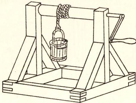
次ニ摩擦アル場合ヲ考ヘン、輪軸ニ於ケル無効抵抗カハ二ツノ性質ニ分ツベシ、即チ一ハ引き上グル荷量ノ多少ニ依リテ變ズルモノ他ハ殆ド常數ナルモノナリ、前者ハ主ニ  $P$  及  $W$  ノ爲ニ發生スル心軸ノ摩擦ヨリナリ、後者ハ主ニ輪軸自身ノ重量ノ爲ニ發生スル心軸ノ摩擦ト鍵鎖若シクハ苧綱ノ部分ニ於テ發生スル抵抗ヨリ成ル、而シテ此
