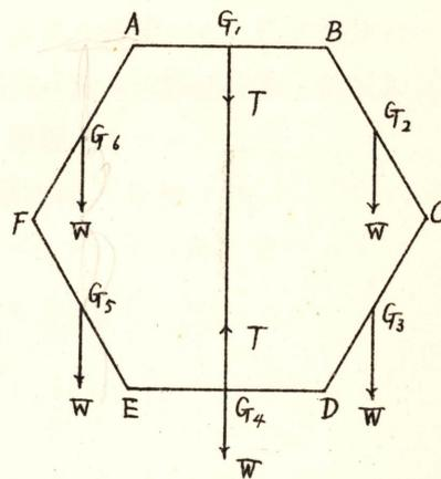
ハズ、物體ガ或平面上ニ置カレタルトキ、物體ト平面トノ接觸點ニ於ケル抗力ノ合力ハ、是等接觸點ノ内ノ外側ニアルモノヲ結ビテ作ラレタル凸多角形内ノ點ヲ通ズルヲ以テ、物體ガ静止ノ状態ニアルタメニハ其ノ重心ヲ通ズル鉛直線ガ上記セル凸多角形内ノ點ヲ通過セザル可ラズ、然ラザレバ物體ハ轉倒スベシ、
