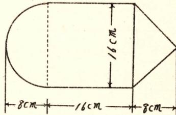
11. 直圓壙ノ一端ニ Conical recess アリ、他端ニ Cylindrical hole アリ、右ノ圖 (c) ハ其ノ横斷面ヲ示セルモノナリ、此ノ物體ノ重心ヲ定メヨ、
