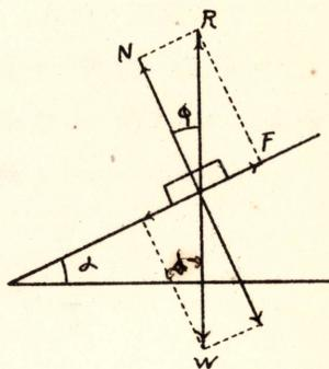
重量  $W$  ノ物體ガ傾斜角  $\alpha$  ノ斜面上ニアリテ Pull 又ハ Push
