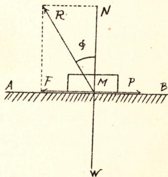
水平力  $P$  ヲ更ニ増シテ或ル範圍以上ニ増大スレバ物體ハ終ニ表面ニ沿ヒテ滑リ始ムベシ、物體ガ將ニ滑ルトキノ摩擦力ヲ最大靜摩擦力 (Limiting static friction) ト云フ、
