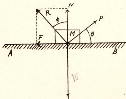
物體  $M$  ヲ加ヘラレタル力  $P$  ガ水平ニアラズシテ其ノ作用線ガ水平方向ニ對シテ角  $\theta$  ヲナセルモノトス、
