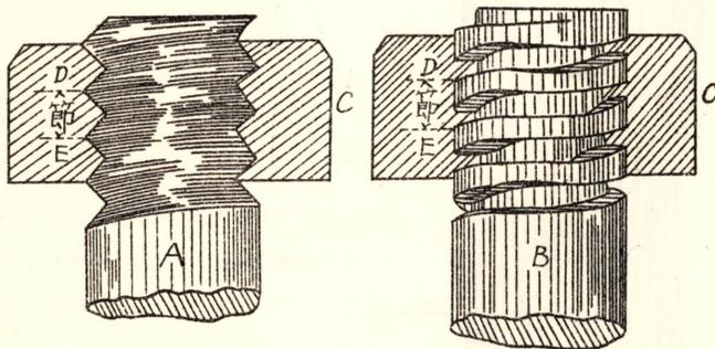
此ノ二ツノモノヲ區別シテ雄螺旋、雌螺旋ト云フ、把手柄チ一廻轉セバ螺旋ハ一節降ル、Wチ螺旋ノ下端ニ抵抗スルカトシ Pチ長サ Rノ把手柄ニ加フル動力トシ Pチ螺旋トス、然ルトキハ
