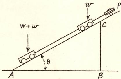
鑛山、石山等ニヨリ利用セラレ山ノ中腹ニ斜面ヲ作り軌道ニ線ヲ敷設シ、頂邊ニ滑車ヲ据エテ左圖ノ如ク之ニ綱ヲ卷キ荷車ヲ聯絡ス、然ル時ハ甲車荷ヲ積ミテ降ル時ハ乙ノ空車昇リ、乙車荷ヲ載セテ降レバ甲ノ空車昇ル、 $W$  ヲ荷重トシ、 $w$  ヲ空車ノ重サトシ、 $\nu$  ヲ摩擦係數トセバ仕事ノ原則ニヨリ
