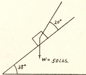
3. 水平ニ對シ  $38^\circ$  ノ傾角ヲナセル摩擦無キ斜面上ニ Weight 50 lbs. ノ物體アリ、斜面ニ對シ  $20^\circ$  ノ傾角ヲナセル綱ニヨリ静止セリ、然ラバ綱ノ Tension, 並ニ斜面ヨリ物體ニ働ケル壓力如何、
