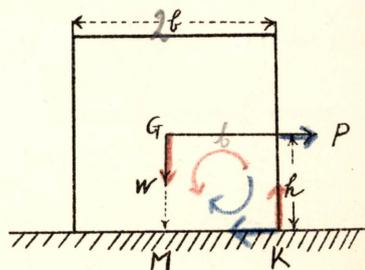
セシメンニハ物體ノ重サヲ  $W$ , 底面ヨリ  $G$  マデノ高サヲ  $h$ ,  $K$  ヨリ鉛直線  $GM$  迄ノ水平距離ヲ  $b$  トセバ
