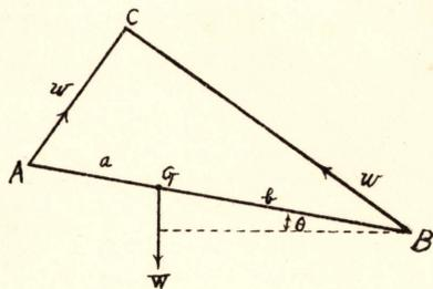
18. 固定セル滑カナル半球 (半徑  $=a$ ) ガアル、之ニ一様ナル真直ナル棒 (長サ  $=2l$ , 重サ  $=W$ ) ガ倚リ掛カツテヘル棒ノ平衡ノ位置ト棒ノ受ケル抗力ヲ求メヨ、
