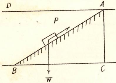
斜面モ亦 Force ratio テ増スニ用フルモノナリ、茲ニ高低ニツノ水平面 AD 及 CB
