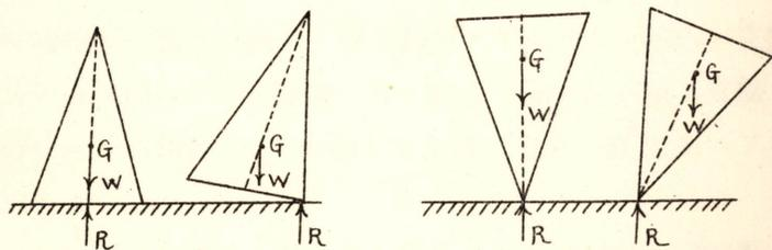
抗力  $R$  トハ偶力ヲナシ圓錐ヲ舊位ニ復セントス、故ニ之ハ Stable equilibrium ナリ、右圖ニ於テハ少シク傾クレバ  $W$  及  $R$  ヨリ成ル偶力ハ圓錐ノ傾斜ヲ益々大ナラシメントスルガ故ニ圓錐ハ忽チ顛倒スベシ、此ノ釣合ヲ Unstable equilibrium ト云フ、又次圖ノ如ク圓錐ガ其ノ傍面ニ於テ水平机上ニ静止スル時ハ斯ノ如キ状態ヲ保チツツ圓錐ヲ机上ニ於テ如何ニ廻轉スルモ  $W$  ト  $R$  トハ常ニ同一鉛直線上ニ作用スルガ故ニ圓錐ハ常ニ平衡状態ニアリ、故ニ此ノ場合ニ於ケル平衡ハ Neutral-equilibrium ナリ、
