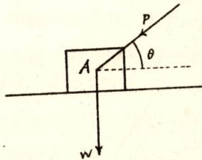
4. 摩擦アル斜面上ニ置カレタル Block アリ、其ノ面ノ Inclination  $27^\circ$  ナリ、Block ハ其ノ Weight ニヨリテ將ニ面ニ沿ヒ Sliding ヲ起サントス、然ラバ Coefficient of friction 如何、
