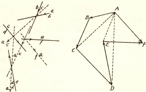
AB, BC, CD, DE, EF ヲ與ヘラレタル諸力ノ Vectors トシ、*ab*, *bc*, *cd*, *de*, *ef* ヲ夫々作用線トス、AB ト BC トノ合力ハ AC ニシテ其ノ作用線ハ *ab* ト *bc* トノ交點ヲ過ギテ AC ニ平行セル *ac* ナリ、AC ト CD トノ合力ハ AD ニシテ其ノ作用線ハ *ac* ト *cd* トノ交點ヲ過ギテ AD ニ平行セル *ad* ナリ、追テ斯クノ如クニシテ與ヘラレタル諸力ノ合力 AF 及其ノ作用線 *af* ヲ得ベシ、
