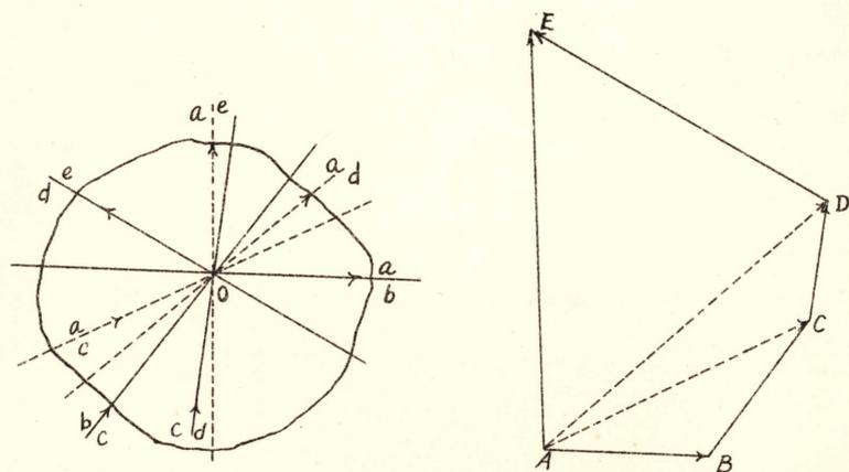
AB, BC, CD, DE ヲ與ヘラレタル諸力ノ Vectors トシ作用線ヲ夫々  $ab, bc, cd, de$  トス、O 點ヲ共通ノ著力點トス、力ノ平行四邊形ノ法則ニヨリ AB, BC ノ表ハセル二力ノ合力ノ Vector ハ AC ニシテ、其ノ作用線ハ O ヲ通ジ AC ニ平行セル線  $ac$  ナリ、Vectors AC ト CD トノ Vectors sum AD ハ Vectors AC, CD
