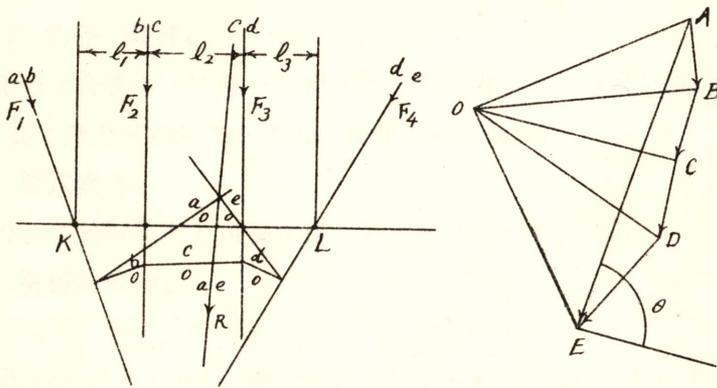
圖式解法ノミヲ試ムベシ、Space diagram ニ於ケル  $\frac{1}{3}$  cm ハ 1 m ヲ表ハシ、Force diagram ニテ  $\frac{1}{6}$  cm ハ 100 kg ヲ表ハセリ、
