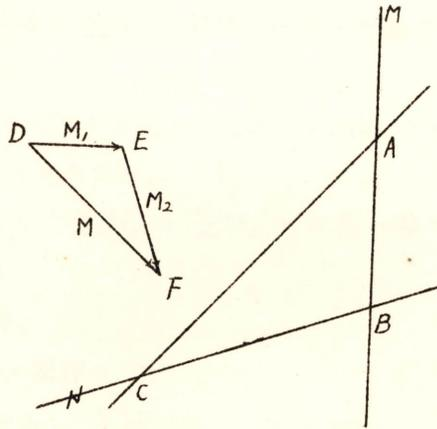
紙面ヲ與ヘラレタルニツノ偶力ノ平面ノ交ハリノ直線ト垂直ニ交ハル平面トス、B ハ紙面ト偶力ノ平面ノ交リノ直線トノ交點ナリ、BM, BN ハ偶力ノ平面ノ切口ナリ、 $M_1$  ヲ平面 BM 上ノ偶力ノ能率トシ、 $M_2$  ヲ平面 BN 上ノ偶力ノ能率トス、 $M_1$  ヲ力ノ大サ F、腕  $l_1$  ナル同一効果ナル偶力ニテ置キ換フ、而シテ其ノ一
