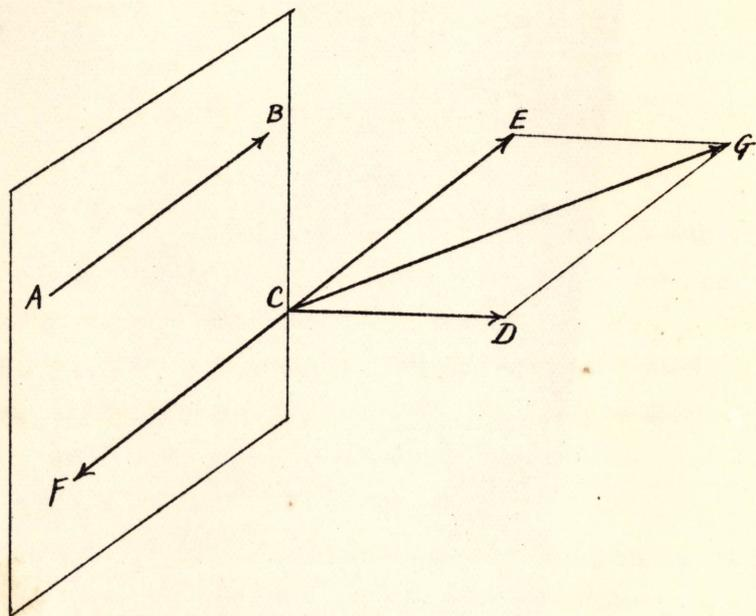
〔證明〕 同一平面上ニ在ラザルニ力ヲ  $F_1, F_2$  トシ其等ノ作用線ヲ夫々  $\vec{AB}, \vec{CD}$  トス、今 C ヲ通ジテ  $\vec{AB}$  ニ平行ナルニ力  $\vec{CE}, \vec{CF}$  ガ作用セリト假定ス、ニ力  $\vec{CE}, \vec{CF}$  ハ等大ニシテ方向反對ニトリ、其ノ大サハ何レモ  $\vec{AB}$  ニ等シカラシム、 $\vec{CE}$  ハ  $\vec{AB}$  ト同一ノ向キトス、
