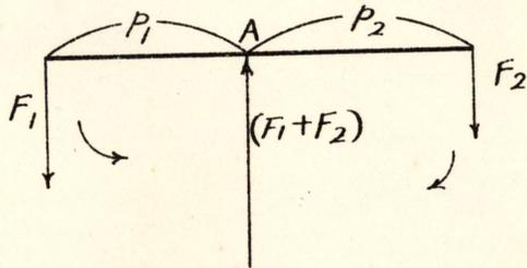
圖ニ示ス如ク一ツノ棒ノ一點 A ガ固定セラレ兩側ニ平行力
