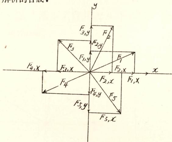
$F_1, F_2, F_3$  等ヲ與ヘラレタル諸力トシ、是等ノ諸力ノ平面上ニ直角座標軸  $x, y$  フトリ、與ヘラレタル諸力ヲ兩軸ノ方向ニ分解ス、 $F_{1,x}, F_{2,x}, F_{3,x}$  等ヲ夫々  $F_1, F_2, F_3$  等ノ  $x$  軸ノ方向ノ分力トシ、 $F_{1,y}, F_{2,y}, F_{3,y}$  等ヲ夫々  $F_1, F_2, F_3$  等ノ  $y$  軸ノ方向ノ分力トス、 $R_x$  及  $R_y$  ヲ夫々合力ノ  $x$  軸及  $y$  軸ノ方向ノ分力トス、然ルトキハ  $R_x$  ハ  $F_{1,x}, F_{2,x}, F_{3,x}$  等ノ代數和ヨリ成リ  $R_y$  ハ  $F_{1,y}, F_{2,y}, F_{3,y}$  等ノ代數和ヨリ成ル、即チ
