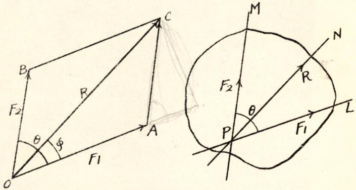
上述ノ事ハ通常力ノ平行四邊形ノ法則トシテ知ラレルモノニシテ平行四邊形 OACB ヲ力ノ平行四邊形トイフ、 $\vec{OC}$  ノ表ハスカヲ  $\vec{OA}$  ノ表ハスカト  $\vec{OB}$  ノ表ハスカトノ合力 (Resultant force) ト云ヒ、 $\vec{OA}, \vec{OB}$  ノ表ハスカヲ  $\vec{OC}$  ノ表ハスカノ分力 (Component forces) ト云フ、二ツノ力又ハ二ツ以上ノカト「同一效果ヲ生ズル」 (Equivalent) 一ツノ力即チ合力ヲ求メルコトヲ力ノ合成 (Composition) トイフ、
