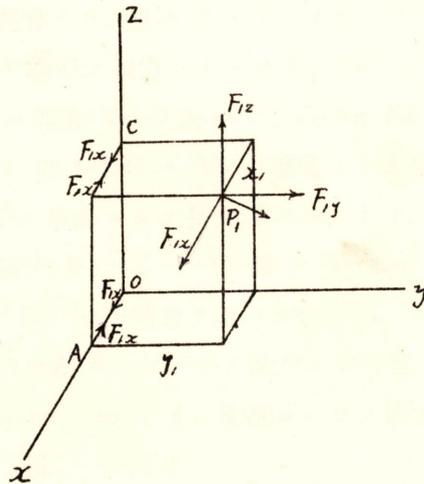
與ヘラレタル諸力ヲ  $F_1, F_2, F_3$  等トス、原点  $O$  ヲ任意ノ位置ニ撰ビ、互ニ直角ニ交ハレル座標軸ヲ採ル、衆力  $F_1, F_2, F_3$  等ノ作用セル點ヲ夫々  $P_1(x_1, y_1, z_1), P_2(x_2, y_2, z_2), P_3(x_3, y_3, z_3), \dots$  等トス、
