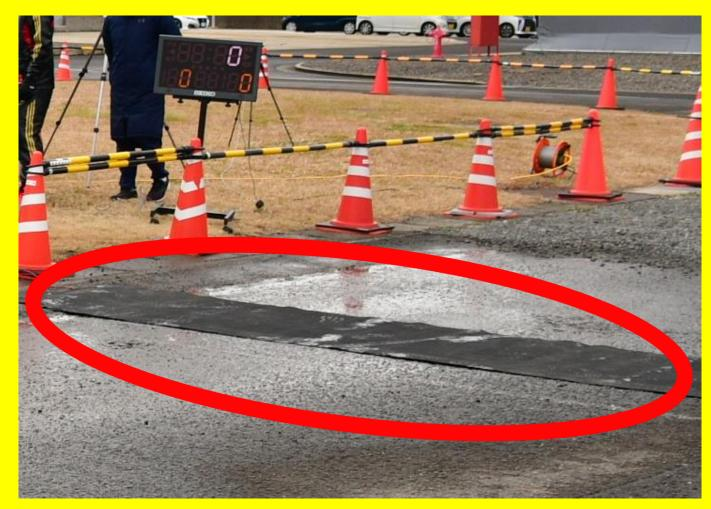
赤丸で囲ってある黒いマットのような物の上を 通過するとセンサーが反応し、正確なタイムを 記録します。
