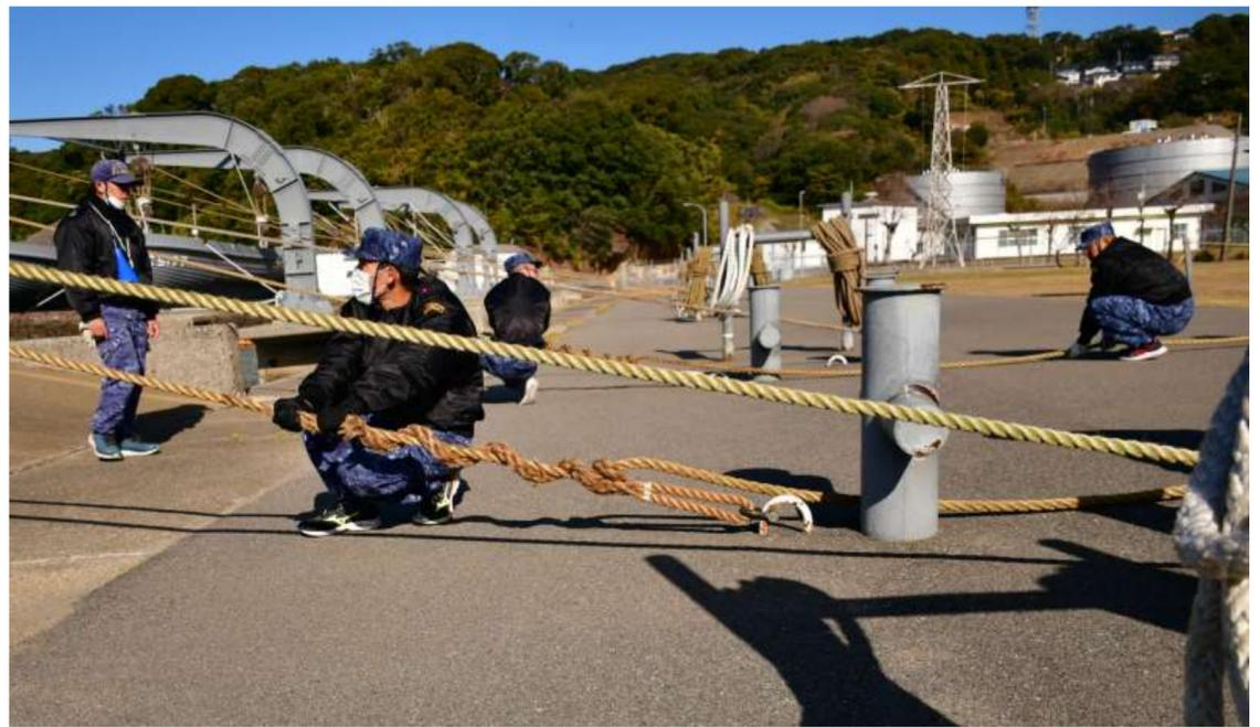
右上の写真がストッパーだけで短艇を支えている状態です。この状態から索を巻き止めます。
