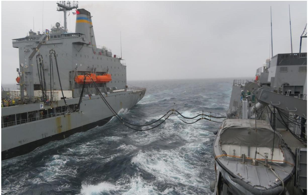
洋上補給を実施中の補給艦「ユーコン」(左) 及び護衛艦「あさひ」(右)
