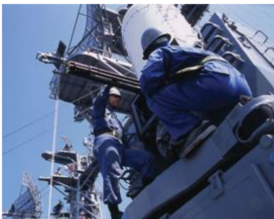
(高性能CIWS速射砲の整備)
