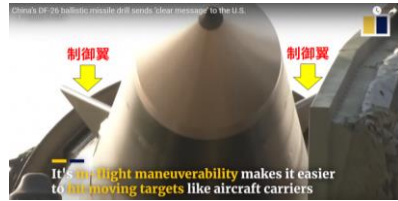
図 9 DF-26 の弾頭部 （出所）South China Morning Post 39 （矢印、日本語は筆者作成）
