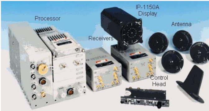
図 1 V-22 オスプレイ等に搭載されている AN/APR-39A (V)2 の信号処理装置、受信装置、表示器、アンテナ等。
