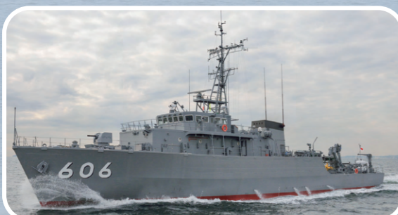
MSC606 掃海艇「はつしま」 基準排水量 570t 全長 60m 速力 14kt
