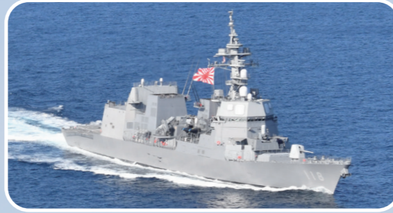
DD118 護衛艦「ふゆづき」 基準排水量 5,100t 全長 151m 速力 30kt
