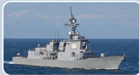
DDG177 護衛艦「あたご」 基準排水量 7,750t 全長 165m 速力 30kt
