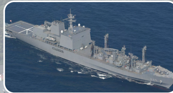
AOE425 補給艦「ましゅう」 基準排水量 13,500t 全長 221m 速力 24kt
