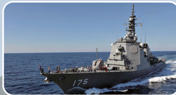
DDG175 護衛艦「みょうこう」 基準排水量 7,250t 全長 161m 速力 30kt
