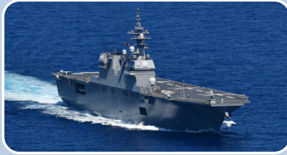
DDH181 護衛艦「ひゅうが」 基準排水量 13,950t 全長 197m 速力 30kt
