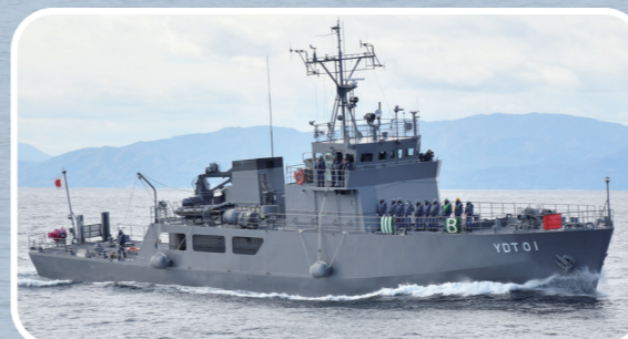
YDT01 水中処分母船1号 基準排水量 300t 全長 46m 速力 15kt
