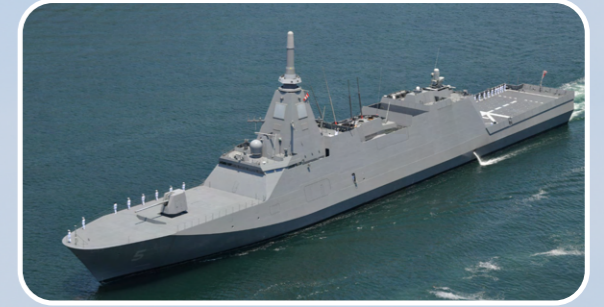
FFM5 護衛艦「やはぎ」 基準排水量 3,900t 全長 133m 速力 30kt
