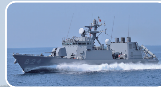
PG824 ミサイル艇「はやぶさ」 基準排水量 200t 全長 50m 速力 44kt
