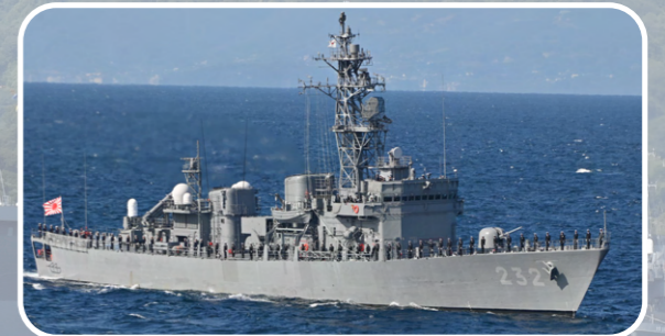
DE232 護衛艦「せんだい」 基準排水量 2,000t 全長 109m 速力 27kt
