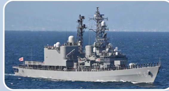
DD156 護衛艦「せとぎり」 基準排水量 3,550t 全長 137m 速力 30kt
