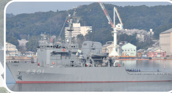
AMS4301 多用途支援艦「ひうち」 基準排水量 980t 全長 65m 速力 15kt
