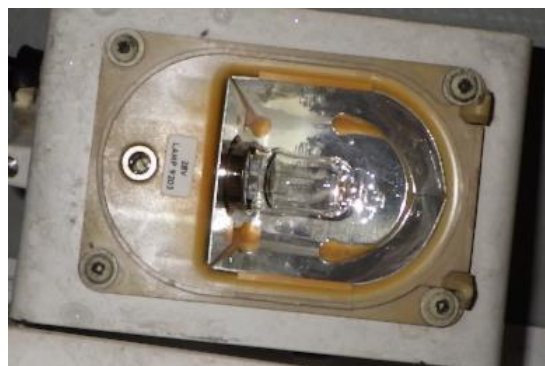
左脚室灯カバー脱落時
