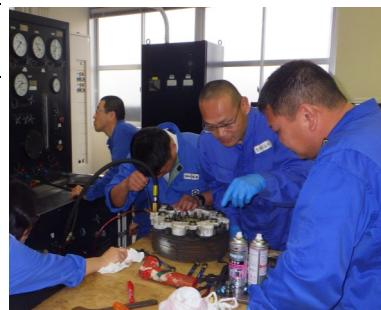
写真はP－3C航空機の油圧ブレーキ整備の様子です。高圧力から低圧力まで様々な圧力をかけて、機能に不具合がないかを検査しています。
