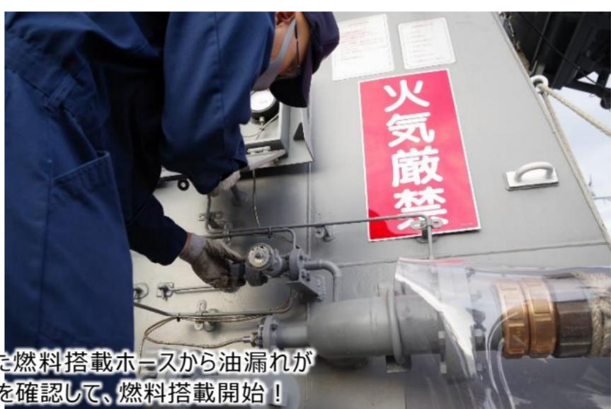
結合した燃料搭載ホースから油漏れがないことを確認して、燃料搭載開始！
