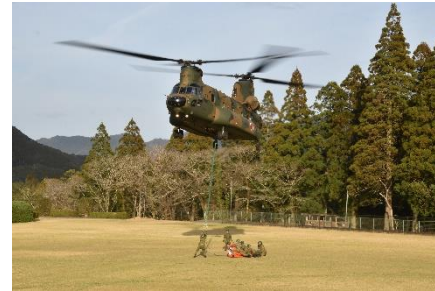
消火バケット取付中の陸自隊員
