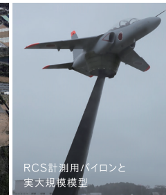
RCS計測用パイロンと実大規模模型
