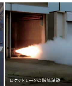
ロケットモータの燃焼試験
