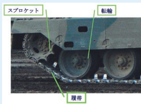
履帯・転輪・スプロケットの説明写真
