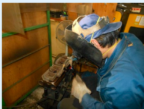
履帯の溶接作業
