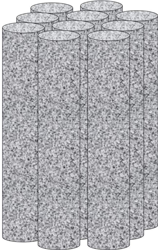
海底面における砂杭の平面配置イメージ
