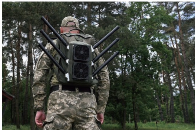
対FPVドローン用バックパック型妨害装置 [KVERTUS AD COUNTER FPV BACKPACK F3U] 【AFP＝時事】
