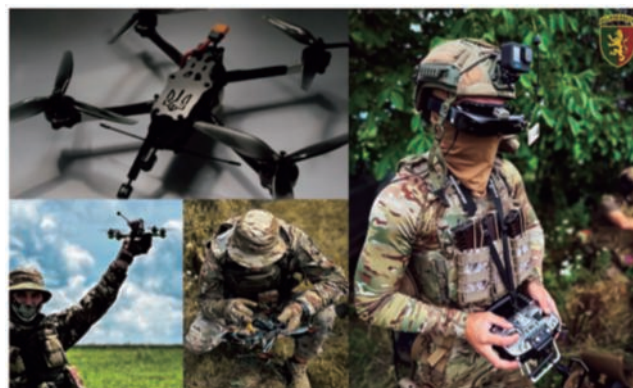
一人称視点タイプのUAV (FPV ドローン) と それを操作する様子【ウクライナ軍】
