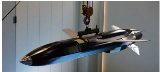
地上での様々な試験に耐えた12式地对艦誘導弾能力向上型（試作品） 【三菱重工業（株）提供】
