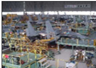
機体の定期修理・改修
