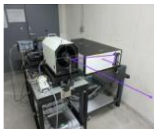
小型ラマン遠隔計測システムの原理検証用試作機の例
