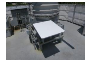
練習艦「かしま」への衛星通信器材装備状況
