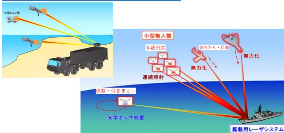
**小型無人機等の飛来する経空脅威へ照射し、熱エネルギーにより物理的に破壊。**
