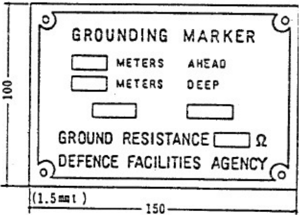
参考資料3 図 11 接地埋設標示板（黄銅製）
