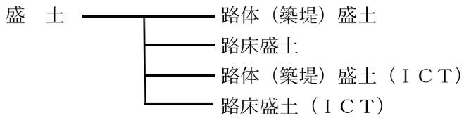
路体（築堤）盛土は施工幅員、路床盛土は平均幅員により下記のとおり区分して算出する。
