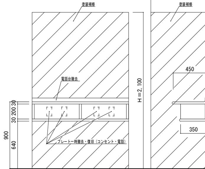
電話台撤去・復旧断面図 (S=1:30)
