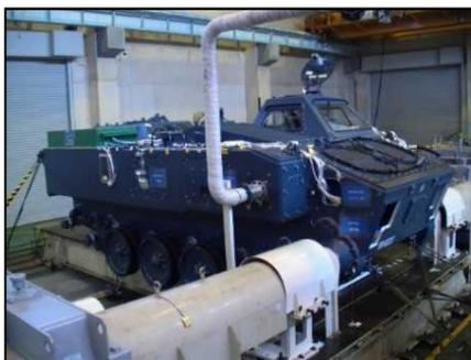
試作車両を用いた機動性の検証試験を実施
