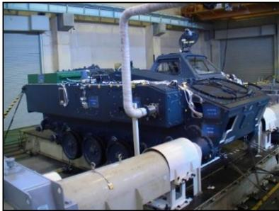
試作車両を用いた機動性の検証試験を実施
