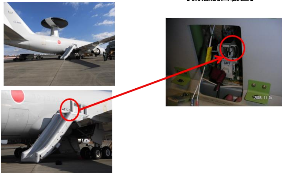
図6 E-767（早期警戒管制機）緊急脱出装置取付位置（一例）
